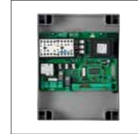
Steuerung für 1 Antrieb bis 1500 W/230 V monophasig oder 2200 W 400 Vac dreiphasig. Programmierung mittels integriertem Display. Steckbarer Funkempfänger Komplette Merkmale auf Seite 158
