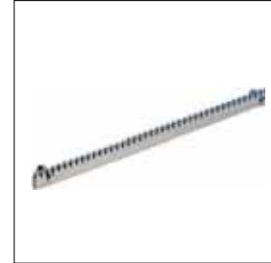
Zahnstange M4 30x12x1000 mm gebohrt und verzinkt mit Distanzstücken und Schrauben 4 Stück pro Verpackung
