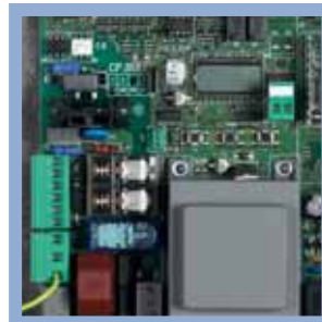
Programmierung mittels LCD Display, rausziehbare Klemmleiste
