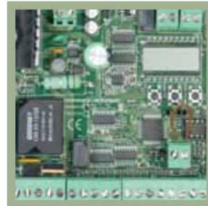
BRAINY24 24 Vdc Steuerung mit eingebautem Empfänger, zahlreichen Betriebslogiken, Programmierung über Display
