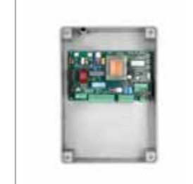
230 Vac-Steuerung mit eingebautem 433,92 Mhz-Empfänger mit 64 Speicherplätze, integriertem Display und festen Verlangsamungen. (vollständige Merkmale S. 153)
