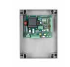
230 Vac-Steuerung mit eingebautem 433,92 Mhz-Empfänger mit 64 Speicherplätze, integriertem Display und zahlreichen Betriebslogiken. Eingänge für Encoderanschluss (vollständige Merkmale S. 152)
