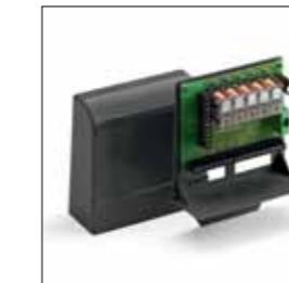
Master/Slave Karte für Schranken, ermöglicht die synchronisierte Bewegung von 2 Antrieben
